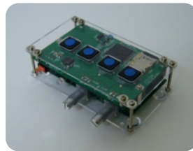
小型化試作 Downsized proto type 開発用ボードで検証したハードウェアを元に小型化した試作機です。 Based on evaluation of development board, downsized proto was developed.
