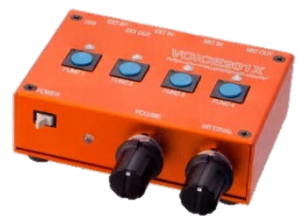
最終試作 Final proto type 最終的な完成品はKEYER2009と同じようなコンパクトなケースに収まります。 Final product will be accommodated in compact chassis like KEYER2009.
