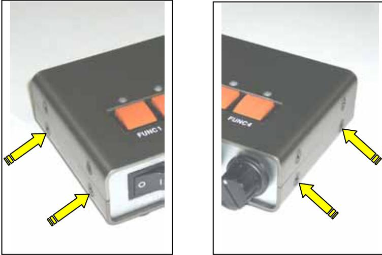
次に底面の 3 本のネジを外します。他の 2 本はスピーカを固定しているネジなので、外さないでください。
